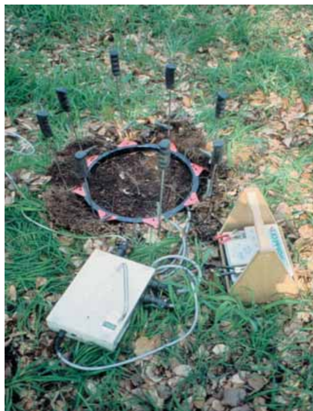
Fig. 8,8 : Différentes techniques pour l'extraction du sol de la faune du sol. Les techniques présentées sont : extraction au formol et tri manuel des vers de terre (photographie de gauche). La méthode électrique pour l'échantillonnage (ci-dessus au centre) et une tarière pour l'extraction des groupes appartenant à la mésofaune (à droite). (Toutes les photographies – JR)
