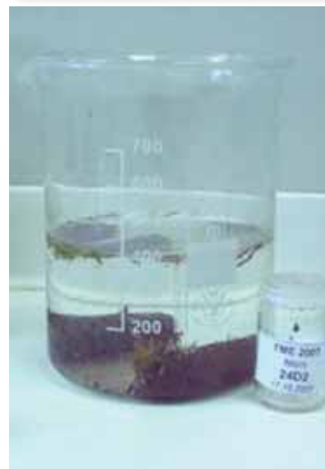
Fig. 8,11 : Méthode de tamisage et décantation modifiée. (JR)
