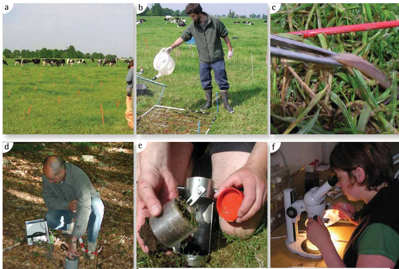
Fig. 8,13 : La succession des étapes nécessaires à la réalisation de certaines de technique de surveillance du sol : (a) Marquage du site ; (b) Extraction de vers ; (c) Collecte de vers ; (d) Mesure de respiration du sol ; (e) Extraction de collemboles et (f) Identification des organismes. (CG, PHK, AB)
