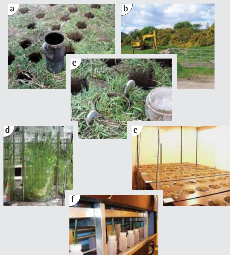
Fig. 4,13 : Tests en mésocosmes: (a-c) Prélèvement des mésocosmes au champ; (d-e) Mésocosmes dans le système de support au laboratoire; (f) Détail du système montrant le dispositif de collecte des percolats sur chaque mésocosme. (BF et JR)
